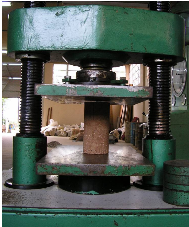
Figura 06: Rompimento dos corpos de prova de Concreto.
