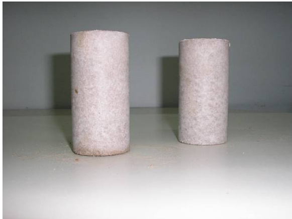
Figura 04: Corpos de prova de Argamassa.
