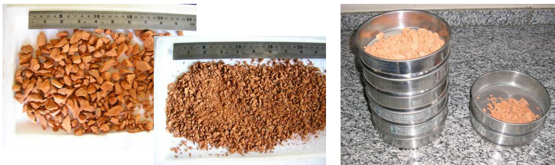
Figura 03: Ensaio da análise granulométrica (caracterização da amostra)
